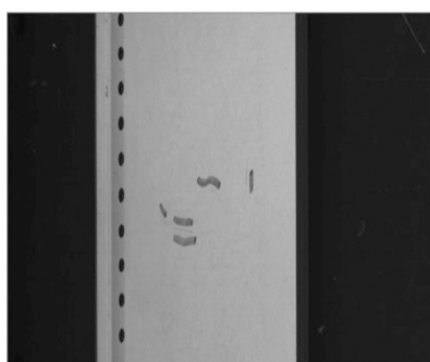
CST-TUG310270-W 金属圆柱划伤检测
