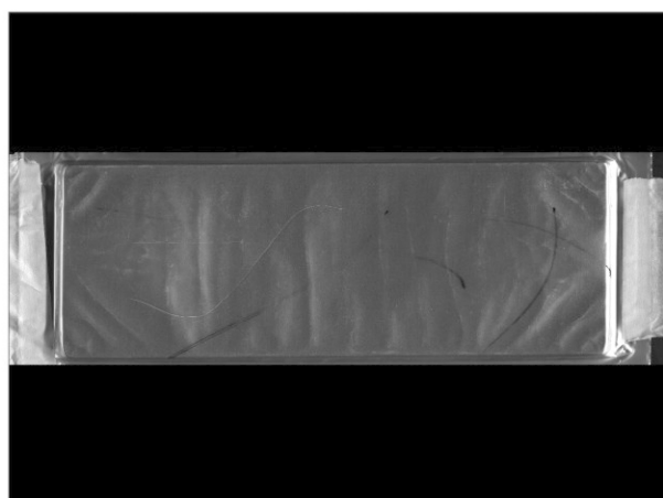
CST-LSH450-W 锂电池表面缺陷检测
