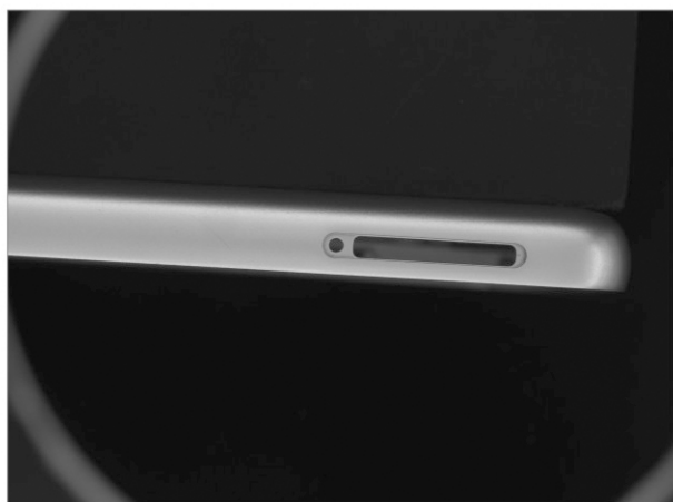
CST-ARS200200-W 手机外壳边缘划痕检测
