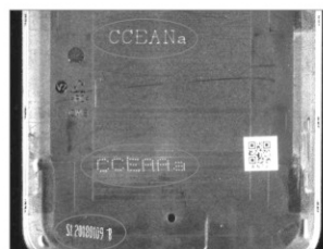
CST-RS9070-W 手机壳字符检测
