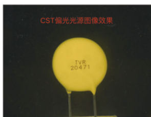
CST-POR8090-W 电容字符检测
